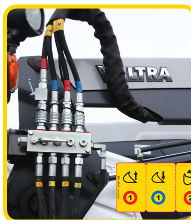
2C002402 B = Midt/laster B fremført til C = ID 1 - 2 - 3 også når fronthydraulikk er montert.
