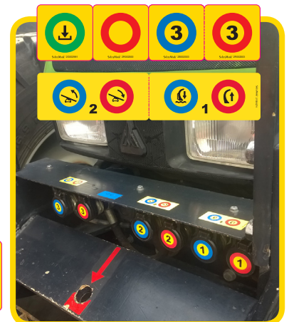
2C002402 B = Midt/laster B fremført til C = ID 1 - 2 - 3 også når fronthydraulikk er montert.
