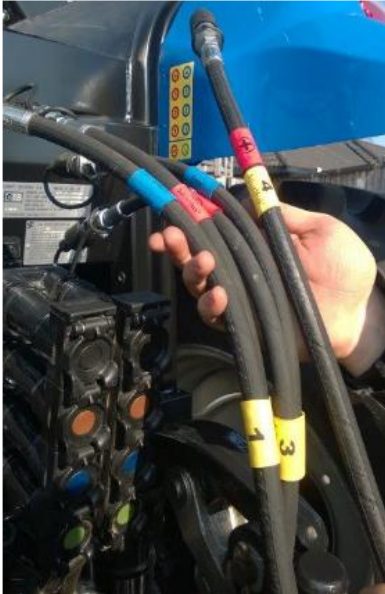
Bilde 14. Merkede hydraulikkslanger SafetyMark, av Paal Sjøberg, 2014.
