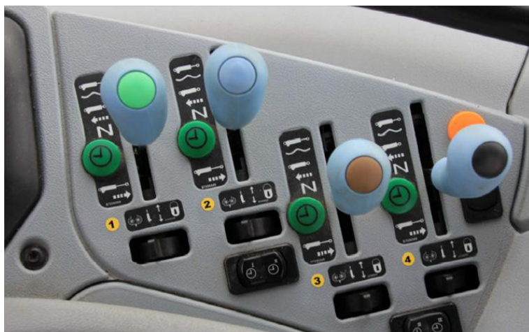
Bilde 15. Merking hydraulikkspaker SafetyMark, av Paal Søberg, 2014.
