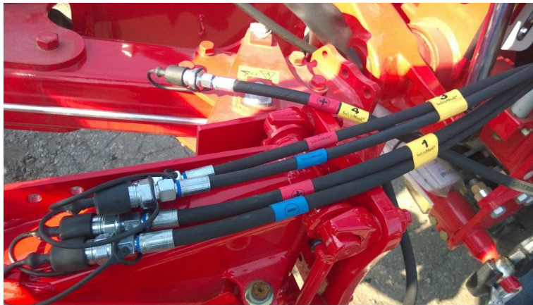
Bilde 10. Merkede hydraulikkslanger plog, av Paal Søbørg, 2014.
