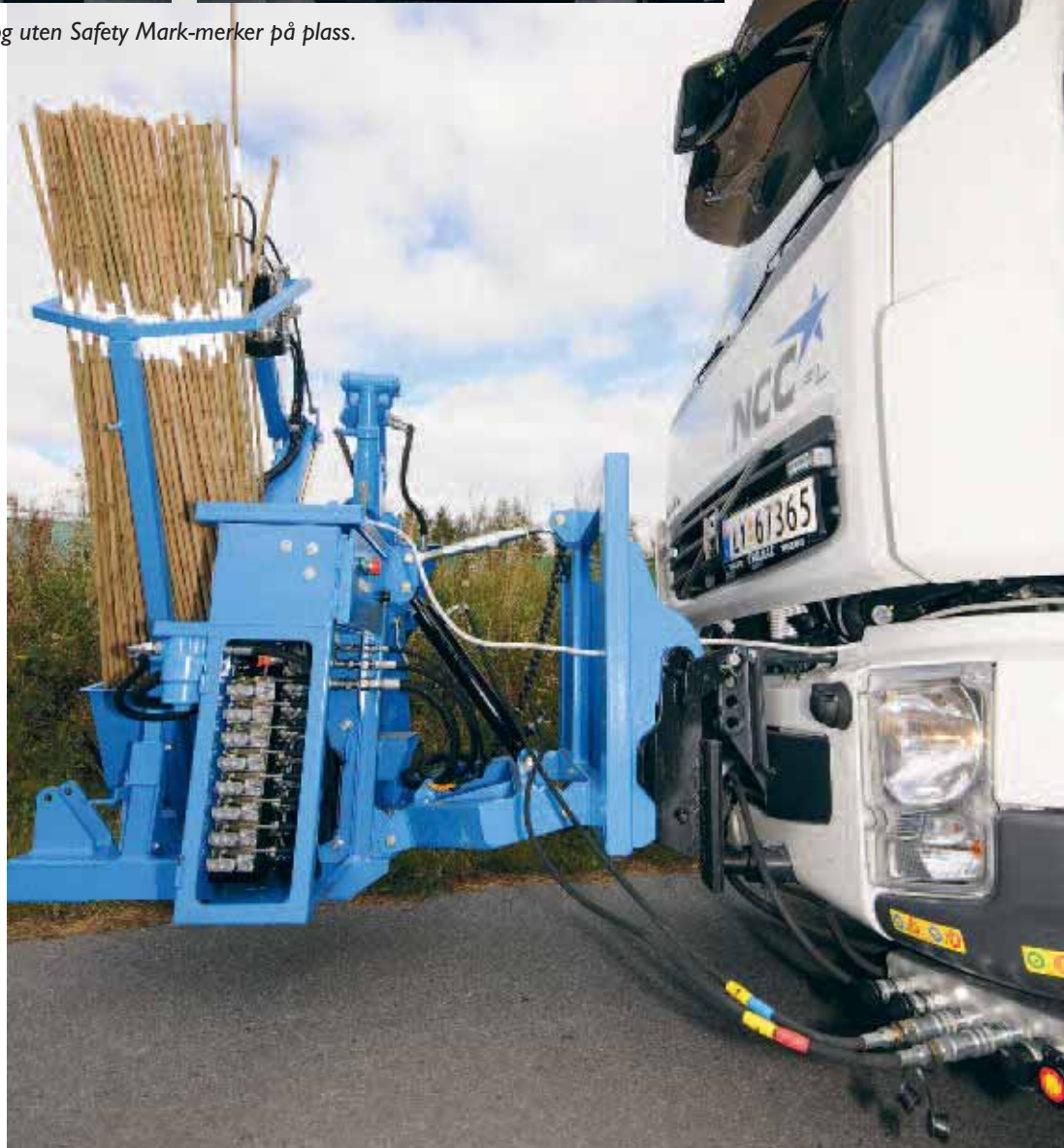
Ved hjelp av farge- og nummerkoder fester man hydraulikkslangene riktig. På bildet en frontmontert Stickset 500, stikkesettingsmaskin fra S. Risa AS.
